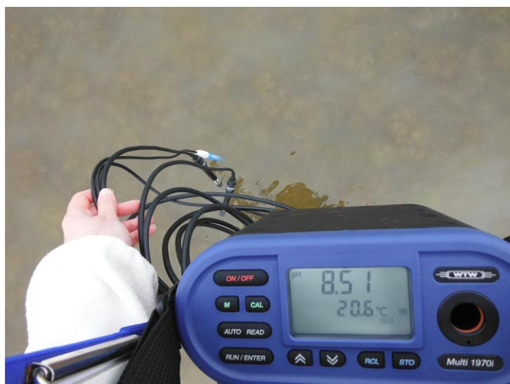
Figure 15 : Illustration du protocole de mesure des paramètres hydrologiques par l'emploi de la sonde WTW-Multi 1970i.
