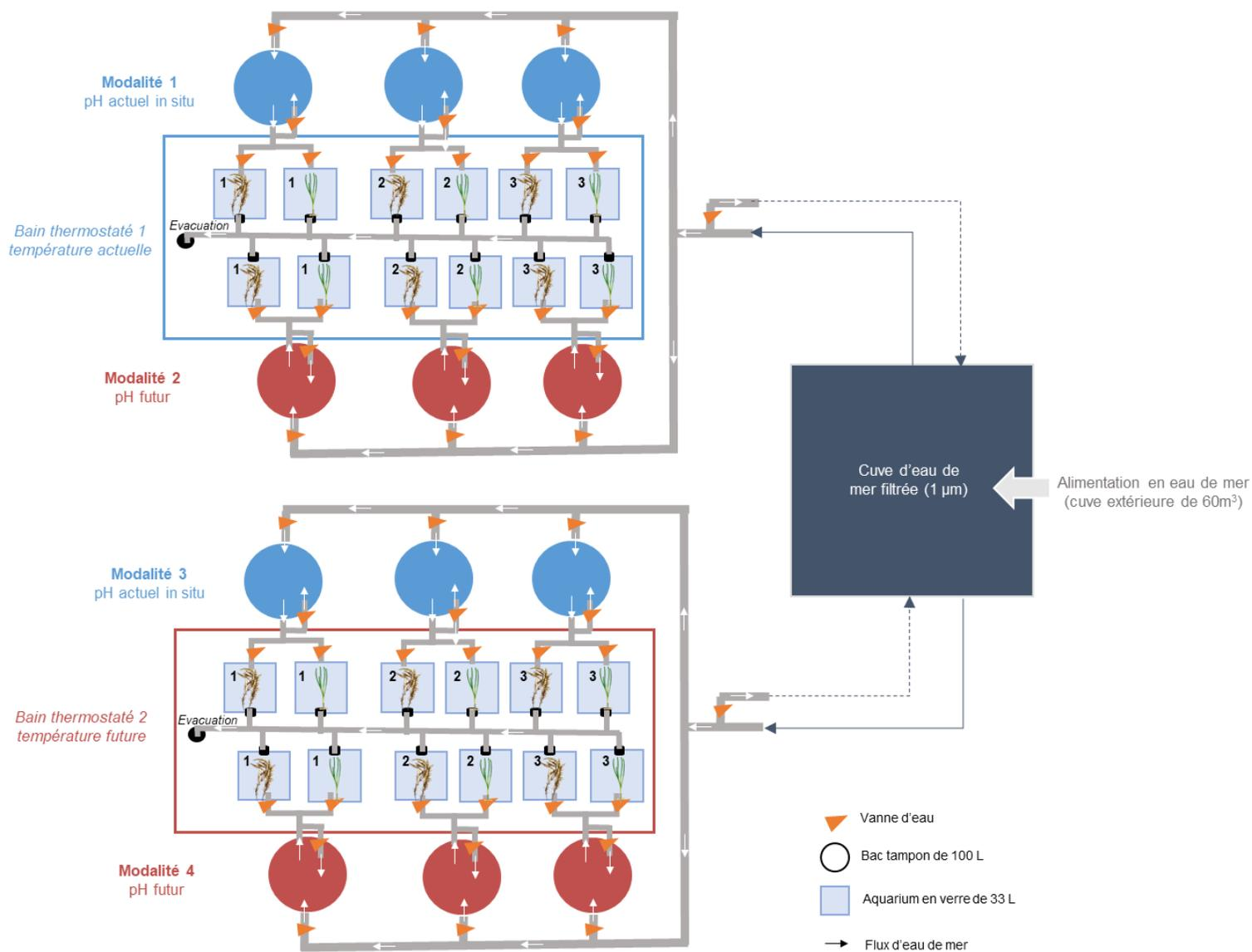
Figure 31. Schéma du dispositif expérimental développé
